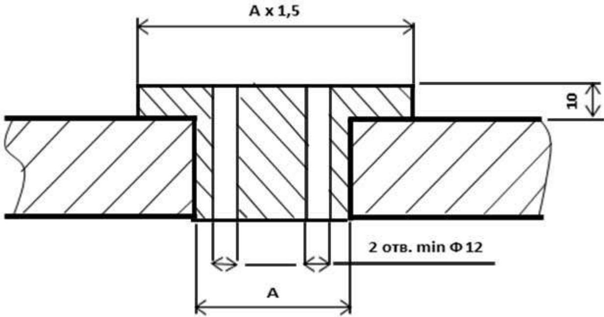
С внешней стороны кузова болт крепления должен иметь металлическую шайбу толщиной 3мм, площадь которой не менее 20 см<sup>2</sup>. Максимальная масса весовых блоков в одном месте крепления, не должна превышать 20 кг.
